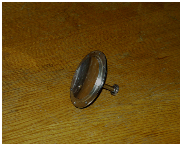
Рис. 9. Зеркало ОР с плавным волноводным переходом
